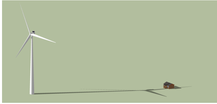
Kuva 1. Varjovälkettä muodostuu, kun tuulivoimala pyörii tarkastelupisteen ja auringon välissä, aurinkoisella ja pilvettömällä säällä.
