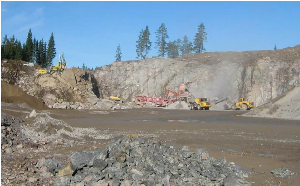
Kuva 3-5. Esimerkki kiviainesottoalueen toiminnasta. Kuvassa vasemmalla porausta, keskellä murskausta, oikealla kuljetusta ja varastointia. Kuva ©: Ympäristöministeriö 2020 / Jari Rintala.
