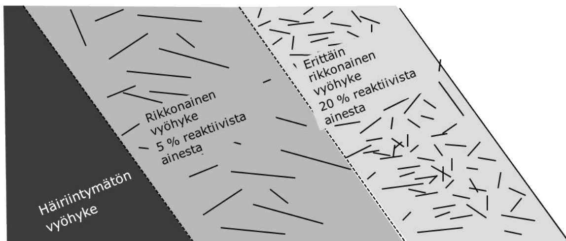
Kuva 2-1 Periaatekuva louhosseinämän räjäytys-ja louhintatöistä aiheutuvasta rikkonaisuudesta.
