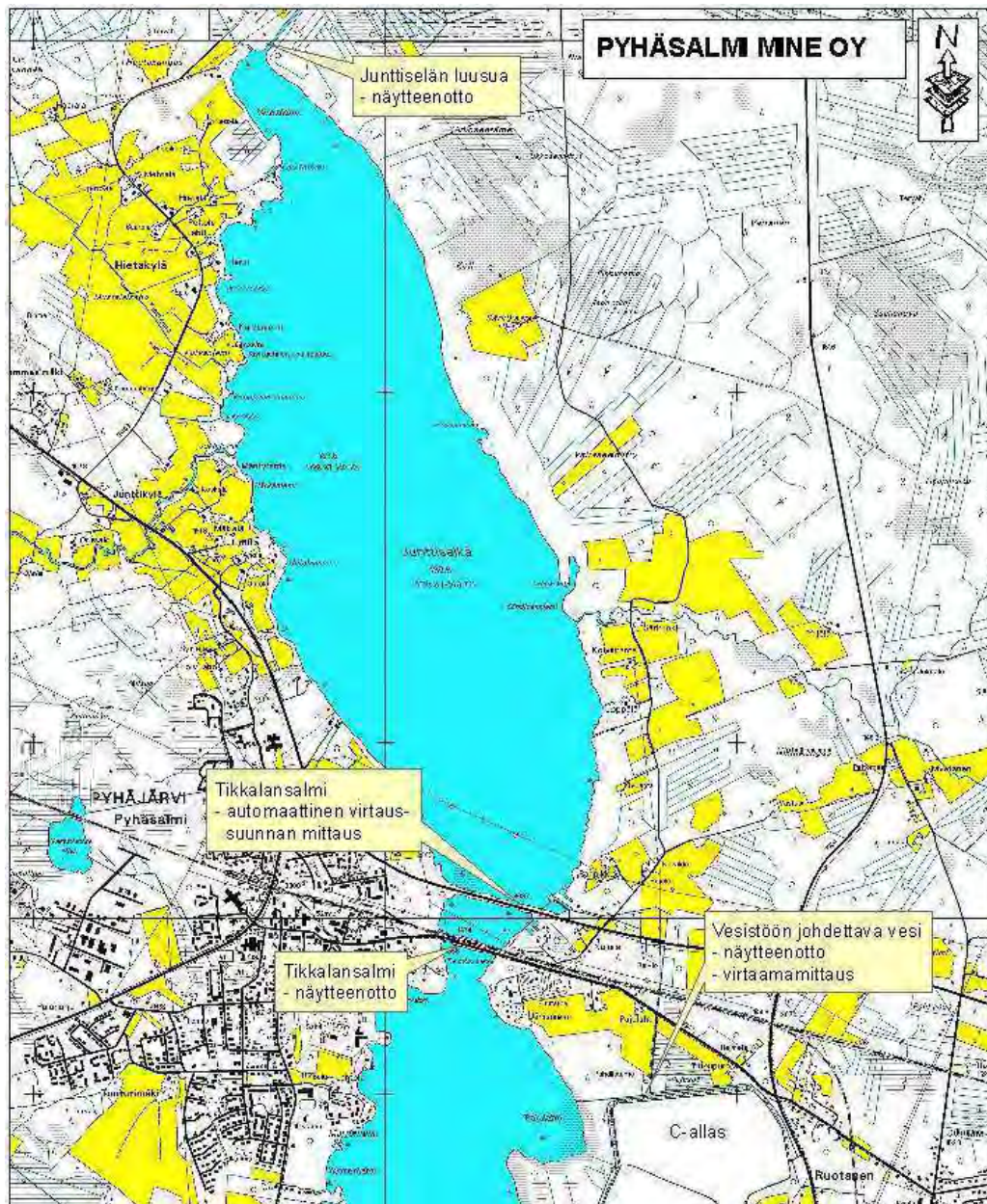
Kuva 1. Vesipäästön ja pintaveden tarkkailupisteet
